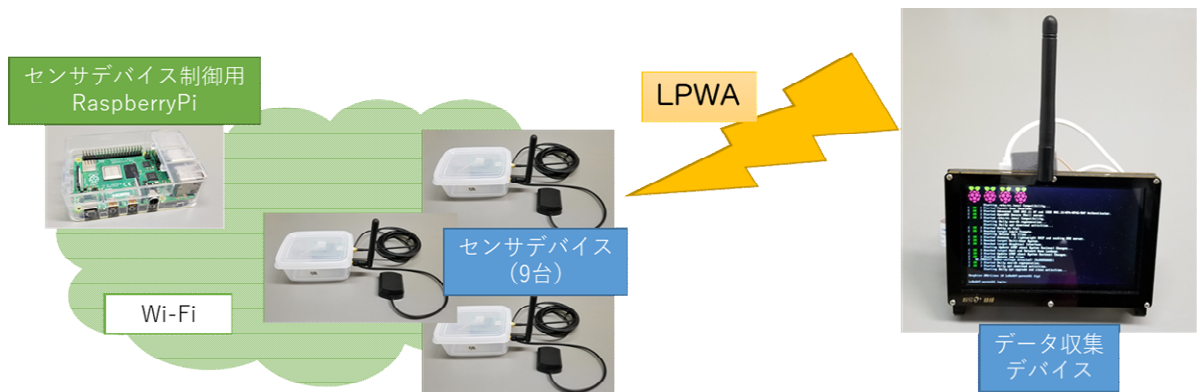
図 4 電波環境（RSSI）測定システム
