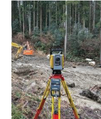
レーザスキャナを 用いた3次元起工測量
